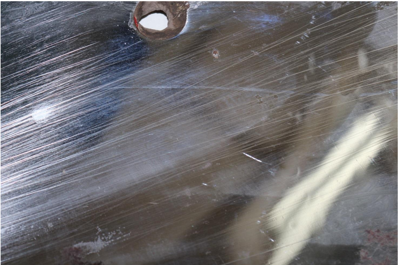
Рис. 4. Поверхня полиці плуга Kverneland (зона 1).
