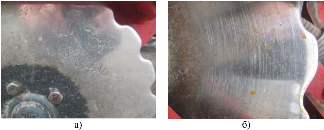
Рисунок 2 – Характерний вид поверхні тертя робочого органу посівного комплексу VADERSTAD Rapid A 800 C: а) зовнішня сторона робочого органу; б) внутрішня сторона робочого органу
