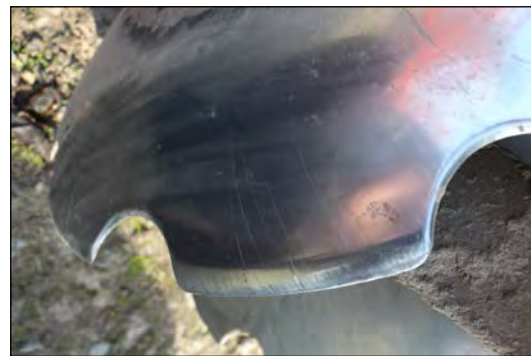
Рис. 6. Загальний вигляд робочої поверхні дискової борони БДВП-7,2 (перший ряд, матеріал робочого органу – сталь 28MnB5)
