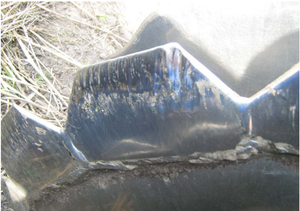
Рис. 2. Електроерозійне покриття робочої поверхні дискових ґрунтообробних знарядь
