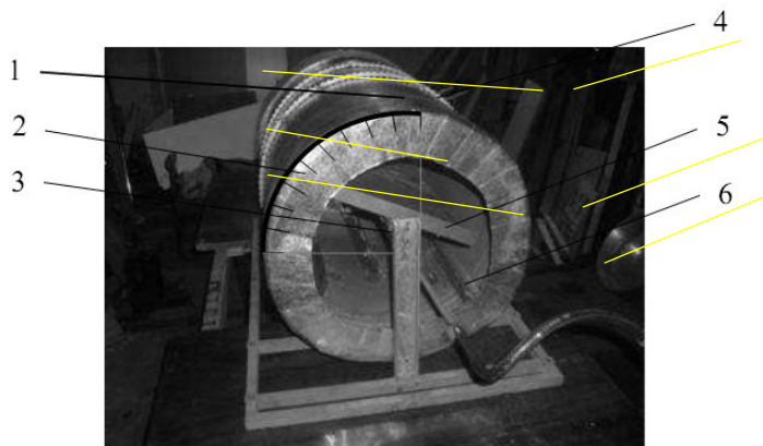
Рис. 1. Модель барабанної сушарки: 1 – корпус барабана; 2 – накладка із органічного скла з нанесеною кутовою шкалою; 3 – ІЧ-випромінювач; 4 – ланцюгова передача; 5 – напрямна похила полицка; 6 – перемішуюча лопатка
